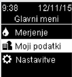
Vključite merilnik, tako da na hitro pritisnete **OK**. V **Glavnem meniju** pritisnite **»,**, da označite **Moji podatki**. Pritisnite **OK**.
