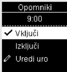
označuje, da je opomnik nastavljen na prikazani čas in samodejno nastavljen na **Vključi**. Če želite izključiti opomnik, pritisnite , da označite nastavitev **Izklijuci**.
