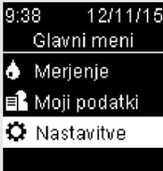
Vključite merilnik, tako da na hitro pritisnete **OK**. V **Glavnem meniju** pritisnite **▼**, da označite **Nastavitev**. Pritisnite **OK**.
