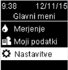
Vključite merilnik, tako da na hitro pritisnete **OK**. V **Glavnem meniju** pritisnite **OK**, da označite **Nastavitev**.
