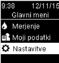
Vključite merilnik, tako da na hitro pritisnete . V **Glavnem meniju** pritisnite , da označite **Nastavitev**. Pritisnite .
