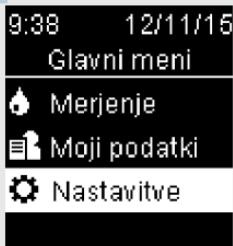
Vključite merilnik, tako da na hitro pritisnete **OK**. V **Glavnem meniju** pritisnite **OK**, da označite **Nastavitev**. Pritisnite **OK**.
