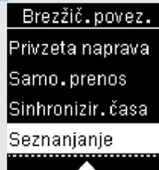
Vključite merilnik, tako da na hitro pritisnete **OK**. V **Glavnem meniju** pritisnite **OK**, da označite **Brezžič. povez.**. Pritisnite **OK**.
